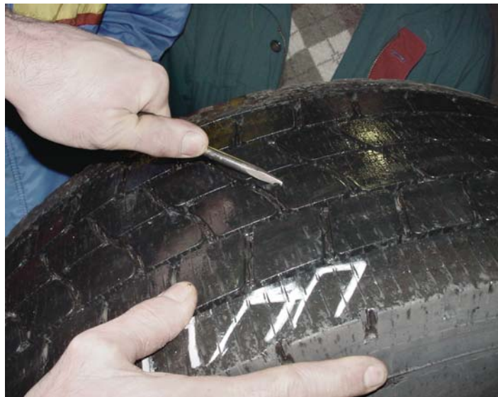
Een spiraalvormig mes kerft ontelbare kerfjes in het loopvlak. Die openen zich pas wanneer ze daartoe worden aangezet door rem- of aandrijfkraften in de rijrichting óf door een schroevendraaier.
