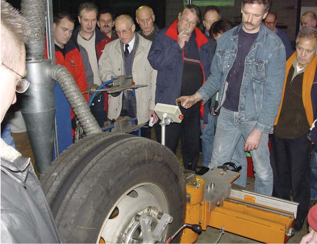
"Laat 'm maar ronken Ernst", instrueert Profile Tyrecenter Tissink eigenaar, Jan Murre, zijn medewerker. De 'ronkende' machine trimt een eivormig wiel tot op 1/10mm perfect rond.
